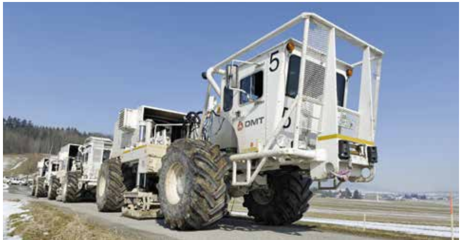
Die rund 20 Tonnen schweren Vibrationsfahrzeuge der deutschen Firma DMT, die Schwingungen im Boden erzeugen und für die seismischen Untersuchungen des Untergrundes eingesetzt werden.
