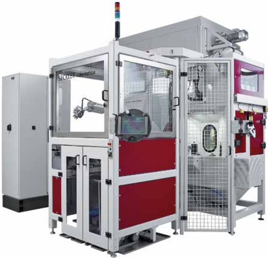
Im Trend sind automatisierte Microstrahl-Anlagen wie zum Beispiel die PEENMATIC 950 ZIDA-Sat mit Roboter-Beschickung, welche exakt auf das Kundenbedürfnis angepasst wird.
