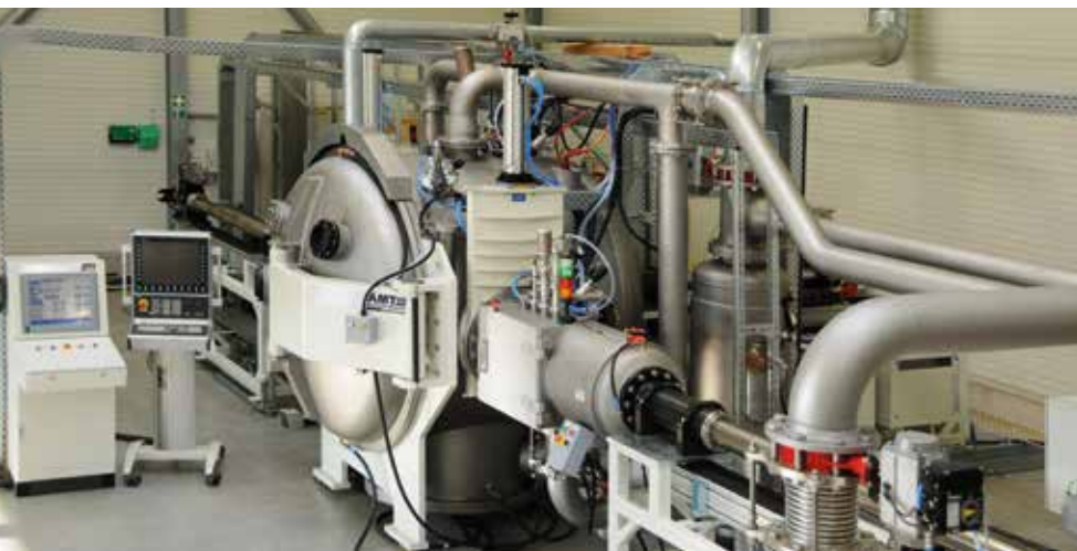
LPCS-Vakuumplasmaspritzanlage der Firma AMT AG in Singapur
