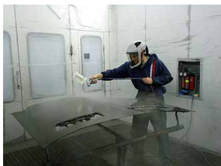
Lackierarbeiten in der neuen Spritzkabine
