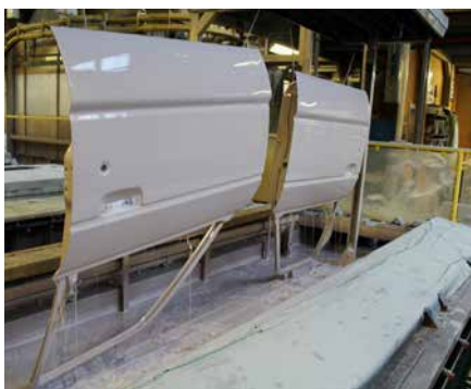
Tauchlackierung: Mit einem der grössten Tauchbecken der Schweiz kann die Lackierwerk Lenzhard AG auch Werkstücke mit grossen Dimensionen verarbeiten.
