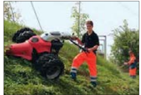
Der moderne, hydrostatisch angetriebene und gelenkte Einachser Combicut Aebi CC66 kann dank dem integrierten Schnellwechselanschluss mit den verschiedensten Geräten und damit rund ums Jahr betrieben werden.
