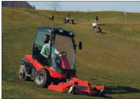
Der neuartige von Aebi entwickelte 3-Rad-Geräteträger Terracut Aebi TC07 ist ein äusserst wendiges (Nullwende-kreis) und hangtaugliches Grünflächenpflege- und Winterdienstfahrzeug mit einem Schnellwechselanschluss mit integrierter Zapfwelle für den Anbau der verschiedensten Arbeitsgeräte.
