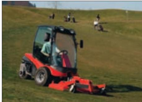
*Der neuartige von Aebi entwickelte 3-Rad-Geräteträger Terracut Aebi TC07 ist ein äusserst wendiges (Nullwendekreis) und hangtaugliches Grünflächenpflege- und Winterdienstfahrzeug mit integriertem Schnellwechselanschluss mit integrierter Zapfwelle für den Anbau der verschiedensten Arbeitsgeräte.*
