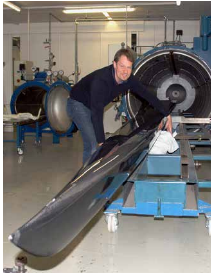
13,5 Meter lang ist der grosse Autoklav der HS-Composite, Horw, aus dem Markus Huser hier ein komplettes Regatta-Ruderboot holt.
