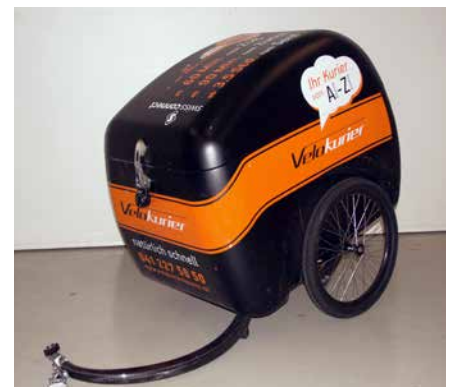
Ein «Ei des Kolumbus»: Der von der HS Composite entworfene, entwickelte und gefertigte Velokurier-Anhänger ist leicht sowie agil und ebenso robust, ein gelungenes Composite-Design.
