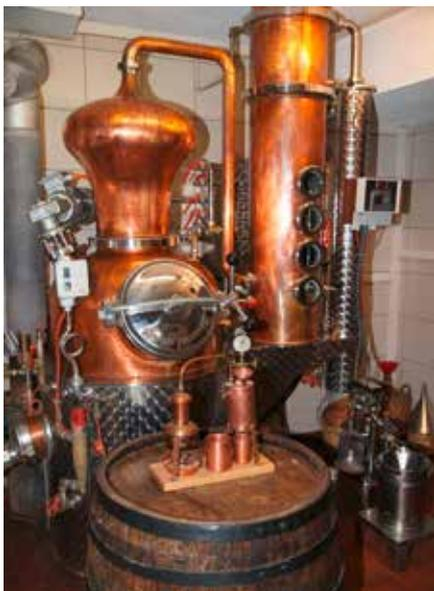
Das Herzstück der traditionellen Familien-Brennerei Stalder an der Kantonsstrasse 2 in Weggis: 150-Liter-Hohlsteinbrennerei mit Rührwerk, drei Böden und einem Katalysator.
