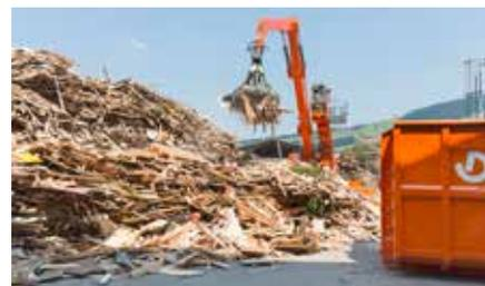
Im Werk 2 in Perlen der Düring AG Ebikon werden jährlich 50 000 Tonnen Altholz in Biomasse zur thermischen Nutzung aufbereitet.
