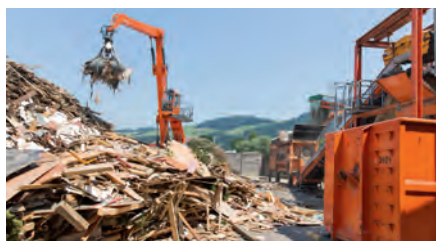
Altholz wird zu Brennmaterial für Schnitzelheizungen und Industrieöfen – im Werk 2 in Perlen.
