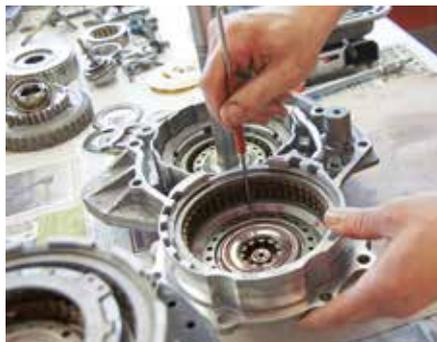
Aus gebraucht mach neu: Automatengetriebe werden kontrolliert in Handarbeit repariert und revidiert.
