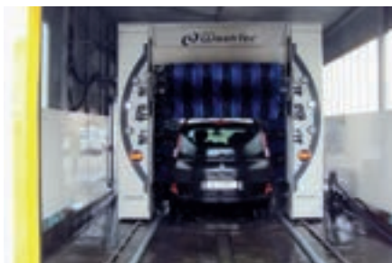
Vollautomatische Waschanlage mit Regenwas- serspülung
