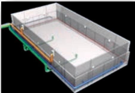
Das Poolbecken ist für höchste Ansprüche an Gestaltung und Materialqualität konzipiert. Dank der Spezialbetontechnik kann rund 60 % Materialanteil gegenüber dem konventionell betonierten Betonbecken eingespart werden. Die Elementteile werden mit nur einem Transport auf die Baustelle geliefert und innert kürzester Zeit vor Ort fertig montiert. Die Bauweise erlaubt es, das Bio-Schwimmbad auch bei unzugänglichen Objekten mittels Helikopter zu bauen.
