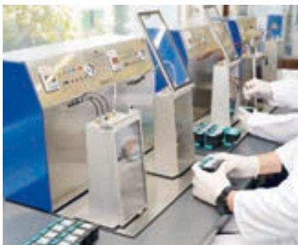
Tintenstrahlpatronen werden gewaschen, geprüft und wieder aufgefüllt.
