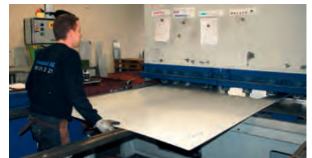
Ebenfalls bis 5 Meter lang kann die Tafelschere Stahlblech und Aluminium bis 10 mm Dicke und Chromstahl bis 8 mm Dicke schneiden.
