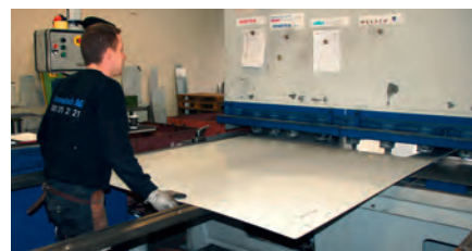
Ebenfalls bis 5 Meter lang kann die Tafelschere Stahlblech und Aluminium bis 10 mm Dicke und Chromstahl bis 8 mm Dicke schneiden.
