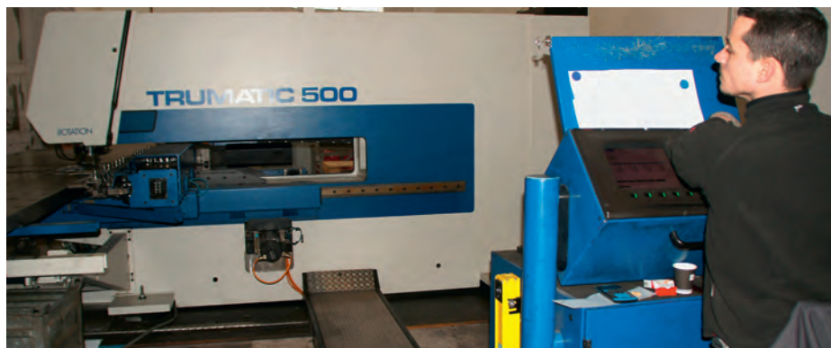
Werkstücke aus Stahlblech, Aluminium und Chromstahl kann die Chronoblech AG an der Lyon-Strasse 40 in Basel mit hoher Massgenauigkeit stanzen.
