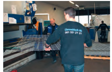
Mit der grossen Abkantpresse können Werkstücke aus Stahl, Alu, CNS, Kupfer, Messing, Lochblech, Plastik – eigentlich alles – von bis zu 5 Metern Länge präzise bearbeitet werden.
