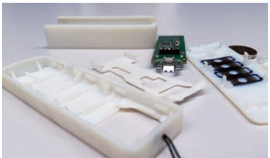
Prototyp, in 3D-Druckverfahren hergestellt
