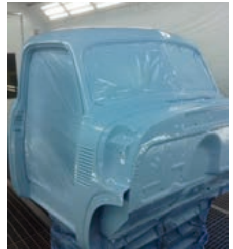
Originalteile vom Chevrolet Pick-up Baujahr 1951, wird in der Originalfarbe neu lackiert.
