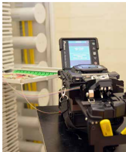
Spleissgerät zum Verbinden der Glasfasern
