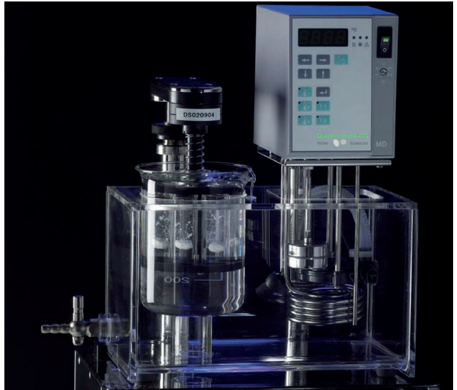
Der DISI-A Zerfallzeittester prüft Tabletten und Kapseln auf Ihre Zerfallzeit, wobei die Produkte zum Beispiel in künstlicher Magensäure bewegt und aufgelöst werden.
