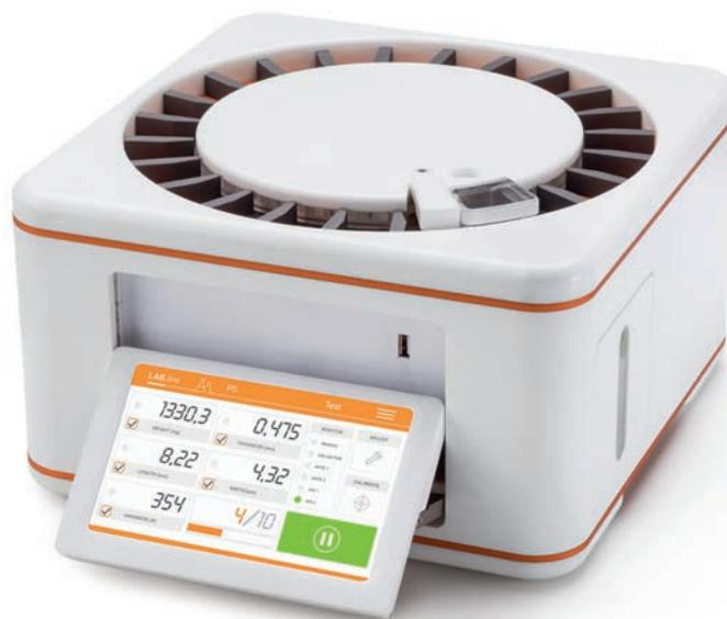
Der P5: Das modulare und kompakte Tablettenprüfgerät für Labore.
