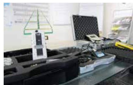
v.l.n.r.: Messgerät für Hochfrequenz, niederfrequente Wechselfelder, Erdmagnetfelder, Scanner für Wechselfelder
