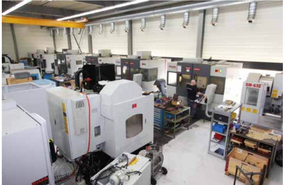
Die 3- bis 5-Achs-Fräsen in Reih und Glied (oben). Die fertigen Teile werden lasergraviert (rechts).
