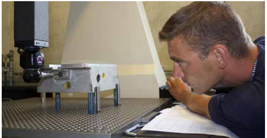
Mit der Messmaschine werden die Bauteile gemessen und protokolliert.
