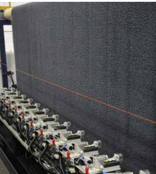
Aus den Teppichrollen werden mit Ultraschalltechnik kleinere Einheiten zugeschnitten.
