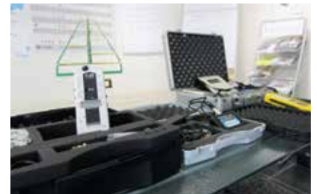
v.l.n.r.: Messgerät für Hochfrequenz, niederfrequente Wechselfelder, Erdmagnetfelder, Scanner für Wechselfelder
