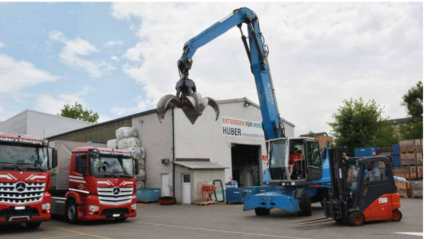
Fuchs-Bagger für den Umschlag der Wertstoffe
