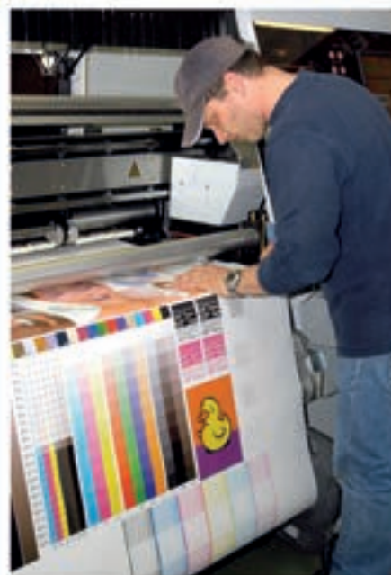
Auf Materialien bis zu 10 cm Dicke kann die alpha sign ag nun auf einer Breite von 250 cm auch Weiss und Lackfarben drucken
