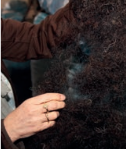
Rosshaare haben eine grosse Festigkeit, nehmen viel Feuchtigkeit auf und sind extrem langlebig.
