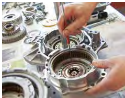
Aus gebraucht mach neu: Automatengetriebe werden in Handarbeit kontrolliert, repariert und revidiert.
