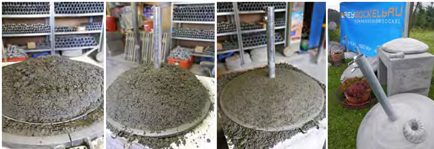
Entstehungsprozess eines Sockels in Handarbeit
