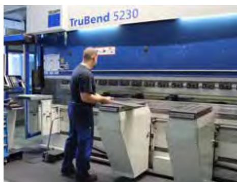
Biegehilfen beim Abkanten sind fast unersetzlich
